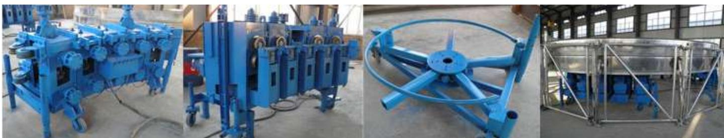
Эта машина Rx4.0m/m предназначена для изготовления стальных гофрированных листов для строительства круглого металлического зернохранилища. Машина разработана на основе Германской подобной машины LIPP-SM40. Конструкция из легированной стали, срок службы длительный. Сопоставляя с SM40, наше оборудование имеет преимущество: монтаж простой, обслуживание и управление удобное.
